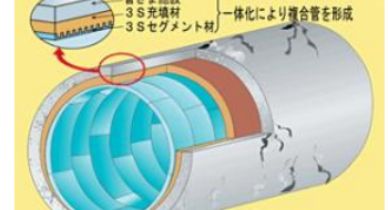
前田建設工業・3Sセグメント工法
