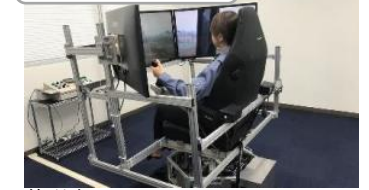
熊谷組・ 無人化施工システム
