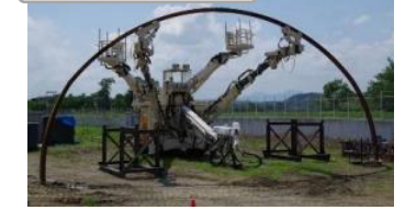
前田建設工業・ 鋼製支保工建込みロボット
